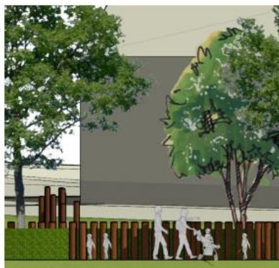
Vue en élévation de l'ouvrage fronton de jeu en extrémité de terrain, constitué de bois de section 15cm, posés tous les 35cm sur hauteur 120cm environ
